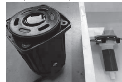
2. Pumpengehäuse 45° drehen im Gegenuhrzeigersinn (links) (nur DM30000S)
